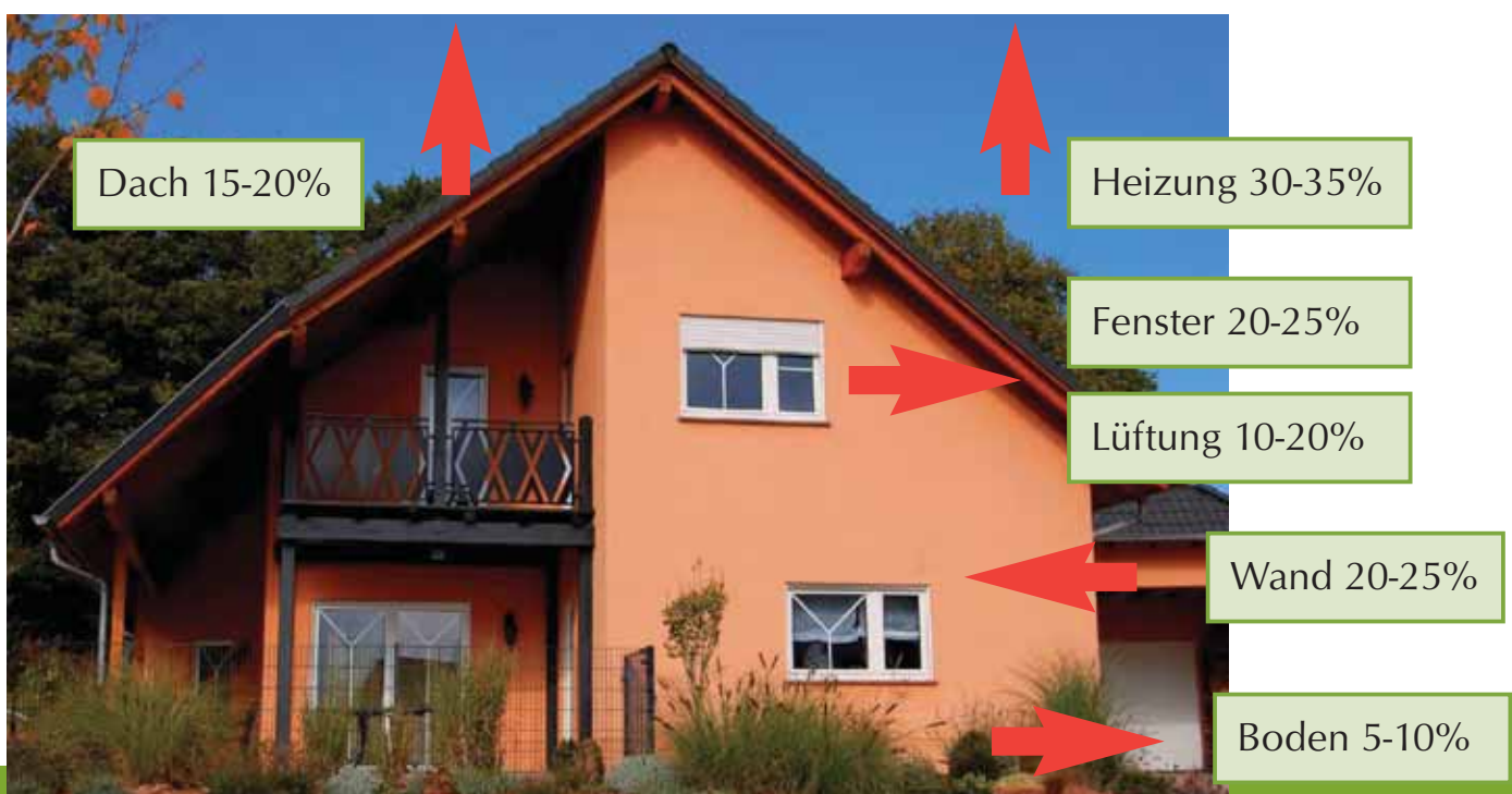
Typische Wärmeverluste eines freistehenden Einfamilienhauses (Baujahr vor 1995)
